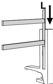
Schieben Sie die Querstangen von oben gleichmäßig in die Nut der beiden fixierten Steher.
