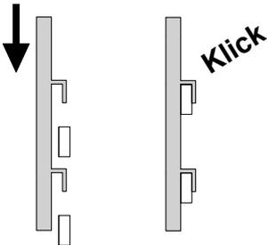
Das Dekor-Element an die Querstangen anlegen und nach unten drücken bis die Klammern in beide Querstangen einklicken. Das Dekor-Element kann nun an die gewünschte Stelle geschoben werden.
