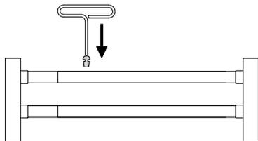
Zur Sicherung der Position einen Sicherungsstift auf den Inbuschlüssel stecken. Diesen Sicherungsstift von oben in den überlappenden Teil der oberen Querstangen stecken.
