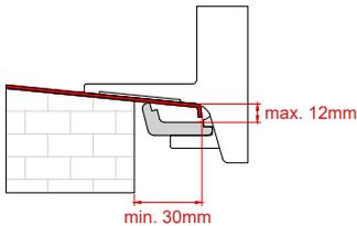
Die Klemmverbindung wird immer zwischen Ober- und Unterseite der Fensterbank hergestellt, aber **NIEMALS** an der Regennase (sonst kippt der Steher).
