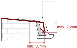
Bei Regennasen bis 25mm Höhe wird der Winkeladapter mit dem langen Schenkel nach oben eingebaut.
