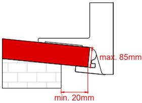
Bei rechteckigem Querschnitt der Fensterbank ist **kein** Winkel-Adapter nötig.
