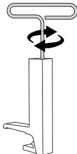
Schraube von oben (im Zentrum des Stehers) mit dem mitgelieferten Inbus-Schlüssel im Uhrzeigersinn (links nach rechts) anschrauben.
