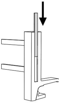
Schieben Sie die Nutblenden von oben nach unten in die offene Nut der äußeren Steher.
